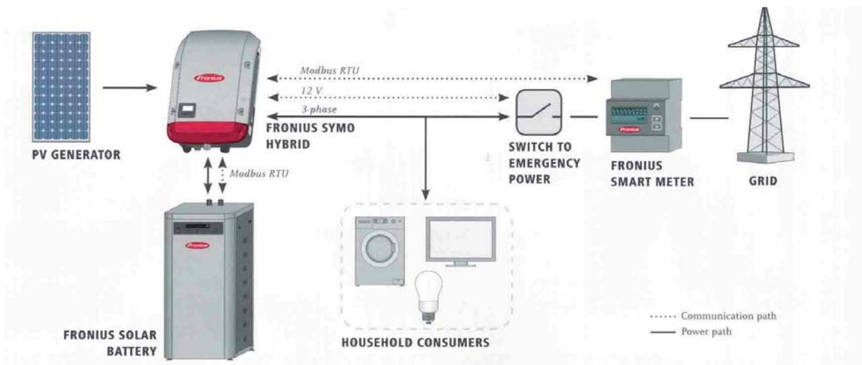
D'une gamme de puissance allant de 3.0 à 5.0 kW, l'onduleur triphasé permet à l'énergie en excès, à partir d'un système photovoltaïque, d'être stockée dans une batterie.
