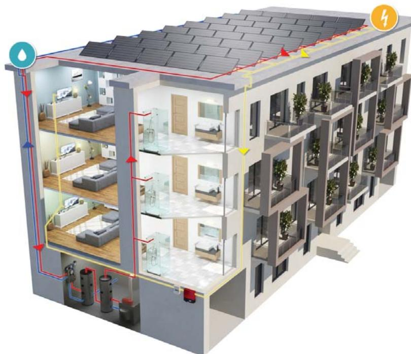
La présence de rayonnement solaire sur la face photovoltaïque du panneau génère également une part importante sous forme de la chaleur (80%) contre 20% pour l'électricité, et ce, de façon simultanée. La chaleur est récupérée par l'échangeur thermique placé en face arrière du panneau, qui sera utilisée pour la production d'eau chaude sanitaire (ECS), ou pour chauffer l'eau d'une piscine, ou bien même pour réaliser du préchauffage pour une PAC.
